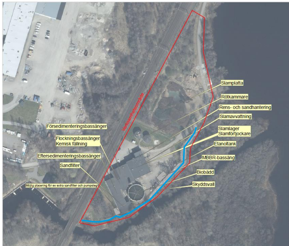
Figur 2. Placering av vall inom befintligt verksamhetsområde för Alvesta reningsverk. Skyddsvallens läge markerad med blå linje och verksamhetsområdet med röd linje.
