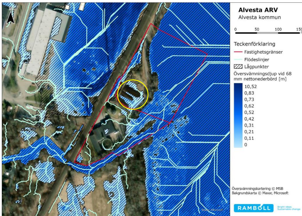
Figur 7. Flödeslinjer och lågpunkter baserat på områdets topografi och översvämningsdjup vid 68 mm nettonederbörd. Fastighetsgränser markerade med rött och reningsverkets slamupplag markerat med gul ring. (Ramboll, 2024).
